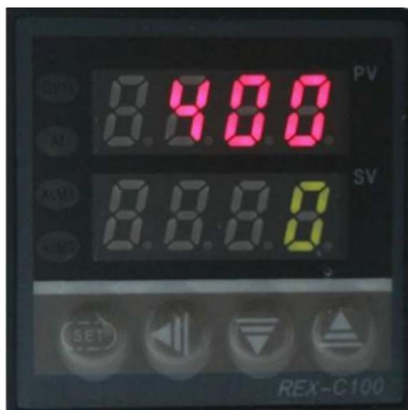
Красными цифрами на верхнем дисплее показана текущая температура (PV), зелёными цифрами — температура, которая установлена (SV). Это та температура, которую нужно поддерживать. При этом, если красное значение ниже зелёного, контроллер подает сигнал реле на нагрев, о чём сигнализирует индикатор самого реле.
